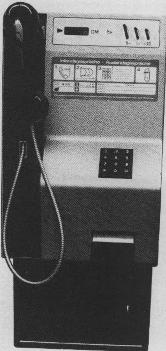
Bild 6: Fernwahlmünzfernsprecher 20
